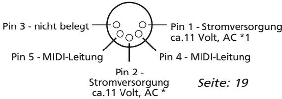
1\*: Die Wechselfspannung an Pin 1 und 2 liegt nur dann an, wenn sich der Schalter 44 in der Stellung "ENGL MIDI Footcontroller" befindet.
