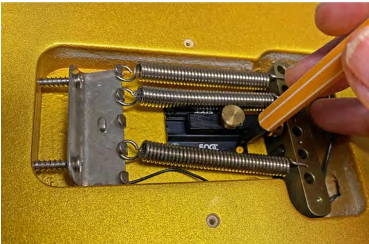
**3. Vorbohren mit 1,5mm Bohrer.**
