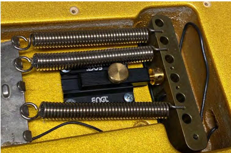
7. Feineinstellung mittels der Rändelschraube mit Zuhilfenahme eines Inbusschlüssels oder eines Schraubendrehers durchführen.
